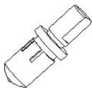
Obr. 3 Zkušební nástroj s ocelovou kuličkou
