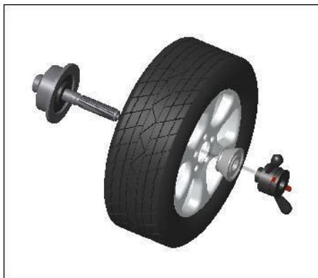
Hlavní hřídel kola – vhodný kužel (malá hlava směrem dovnitř) – rychloupínací matice
